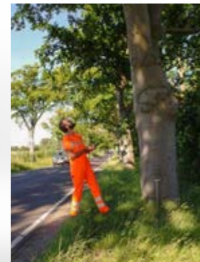
Ein Mitarbeiter der Straßenbauverwaltung kontrolliert einen Straßenbaum durch eine Inaugenscheinnahme vom Boden aus.
